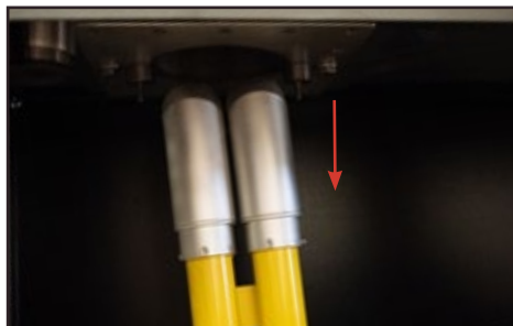
5 - Sfilare il bruciatore dal suo alloggio
