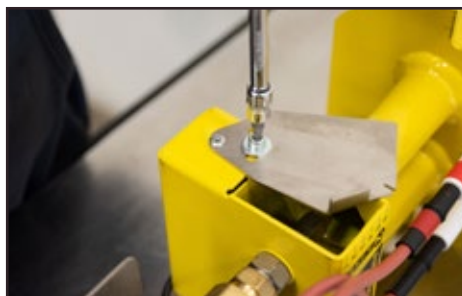
2 - Rimuovere la vite posta sul regolatore d'aria
