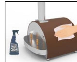
**5. Protection de l'acier inox.** Pour protéger au mieux les pièces en acier inox, il est recommandé d'utiliser de l'huile de vaseline ou d'autres solutions détergentes neutres (pH 7) ne contenant pas d'acides, de white spirit ou de xylène. Utilisez un chiffon doux et non abrasif pour l'application. En cas d'installation dans des lieux en bord de mer, afin d'éviter la corrosion et les incrustations, il est conseillé de nettoyer souvent le four à l'eau douce.
