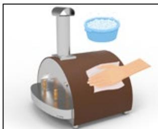
**4. Nettoyer les pièces en acier inox.** Les fours Alfa sont construits avec de l'acier inox à l'extérieur et de l'acier inox à l'intérieur. Pour nettoyer ces surfaces, nous recommandons un produit adapté à ce type d'acier. Nous vous recommandons également de lire attentivement les instructions et le mode d'emploi du produit en question. N'utilisez jamais des nettoyants contenant de l'acide, du xylène ou du white spirit. Rincez bien après avoir nettoyé le four.
